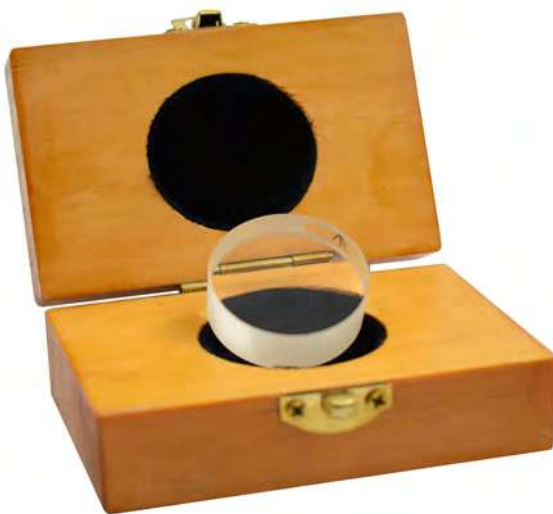
Abstand zwischen den Strichen ca. 0,27 µm Distance between strokes about 0,27 µm
