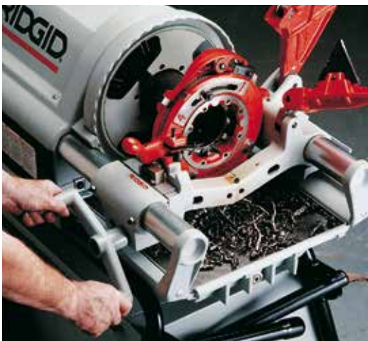
Model 714 (914) narezna glava s uzmicanjem noževa.
