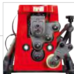
Rotirajuća glava s ugrađenim tlačnim valjcima
