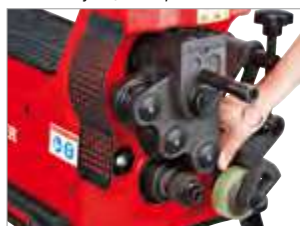
3 mogućnosti postavljanja veličine tlačnih valjaka, bez uporabe alata
